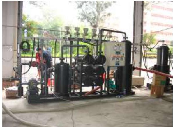
华南农业大学生物质气化技术试验装置现场
